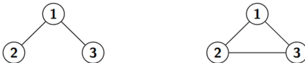
Per ciascuna coppia di pin, in entrambi i progetti il tester dirà che sono connessi, quindi non c'è modo di distinguere i due progetti.
