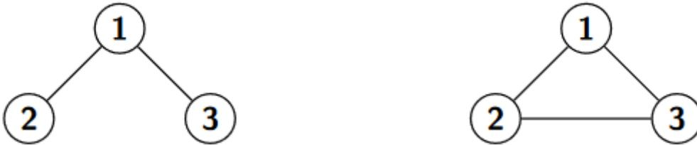
Der Tester würde jedes Pin-Paar für beide Designs als verbunden melden, so dass wir nicht in der Lage sind, sie mit der oben beschriebenen Software zu unterscheiden.
